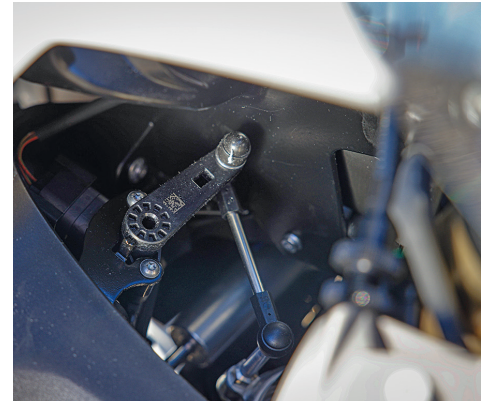
Kleines Bauteil, große Wirkung. Der Linkwinkel-sensor der S 1000 RR macht die Funktionsweise der neuen Slide Control überhaupt erst möglich.
