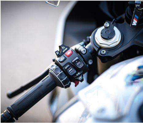
Egal, ob Tempomat oder Slide Control, auch 2023 wird die Elektronik über das bekannte Einstellrad am linken Lenkerende gesteuert.
