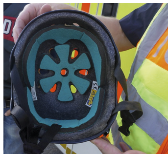
Die Styroporausstattung eines Skateboardhelmes ist für die Dämpfung der Aufprallenergie bei
