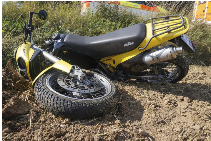
Die komplett abgebrochene Gabel zeugt von der hohen Aufprallenergie.
