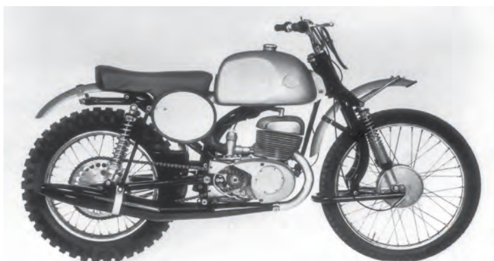
Die Moto-Cross-Version mit dem 26 PS starken 250er Motor: Neben der fehlenden Beleuchtung ist hier die Auspuffanlage unten geführt, weil beim Moto-Cross keine Wasserdurchfahrten und Schlammflöcher üblich sind.
