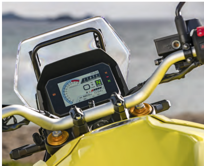
Das 5 Zoll TFT-Display zeigt alle wichtigen Infos an, während der Fahrer am breiten und hohen Lenker die V-Strom bestens im Griff hat.
