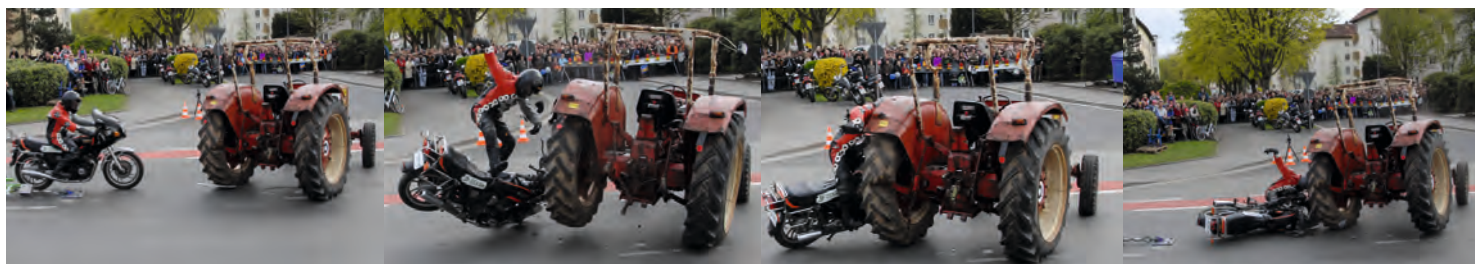
Bei einer Demonstration anlässlich der Kuzlbacher Bikersternfahrt kracht die auf 70 km/h beschleunigte Yamaha mit dem Dummy in den „abbiegenden Traktor“. Dieser bewegt sich aufgrund seiner Masse nur minimal, während der Fahrer hier auf das Hinterrad prallt.
