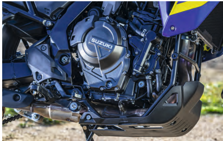
Mit dem 84 PS starken und 776 ccm großen Parallel-Twin ist Suzuki ein großer Wurf gelungen; er treibt auch das Naked-Bike GSX-8S an.
