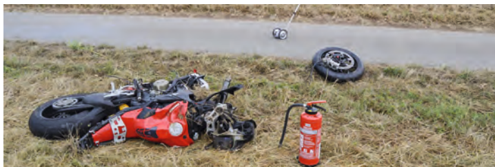
Beim Aufprall auf das Vorderrad des Traktors wurde die Gabel der Ducati abgerissen.
