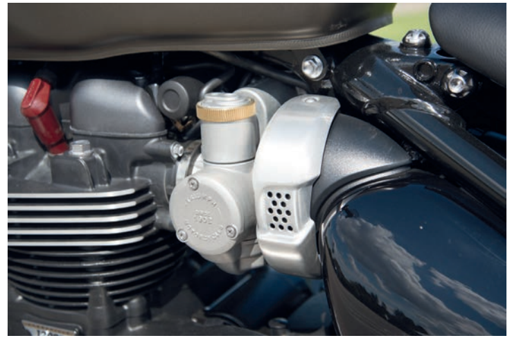
Triumph-Spezialität: Sieht aus wie ein Vergaser, ist aber die Einspritzanlage ins Saugrohr.
