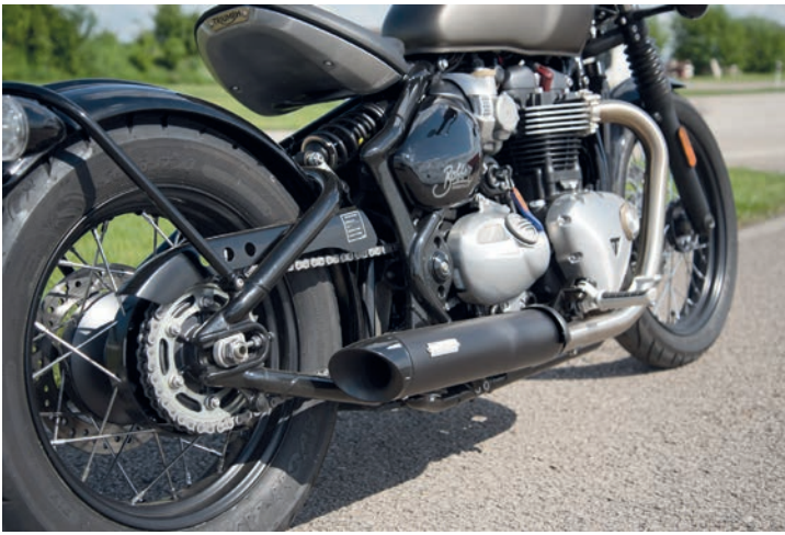
Das Zentralfederbein liegt gut versteckt unter dem Sattel, die montierte VANCE & HINES-Auspuffanlage stammt aus dem Zubehörkatalog.
